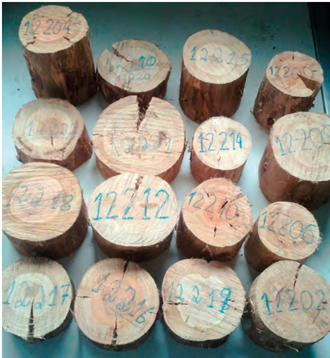
CALIDAD DE LA MADERA: muestras para análisis de laboratorio de densidad y rendimiento de la madera de varios clones
