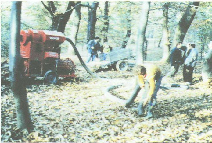
Foto 22. Cosecha mecanizada con sistemas de aspiración mediante tubos laterales de 25 metros. Italia, 1993.
